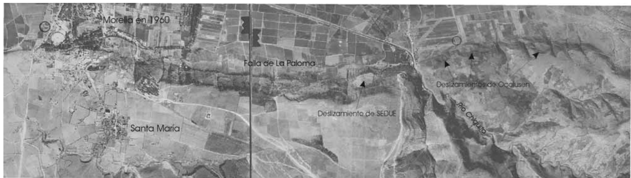
Figura 7. Talud de la falla La Paloma. Se pueden apreciar con bastante claridad los bloques movidos, aparentemente asociados a eventos sísmicos.
